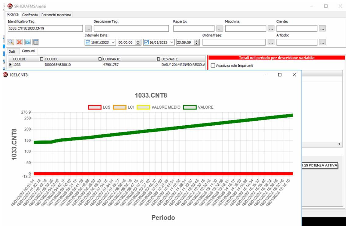
Il modulo SPHERA ENERGY offre un sistema di allerta avanzato che permette di monitorare e gestire in modo proattivo il consumo energetico delle macchine e dei processi produttivi. Una delle caratteristiche più importanti è la possibilità di impostare allarmi per il superamento delle soglie di consumo energetico predefinite.
