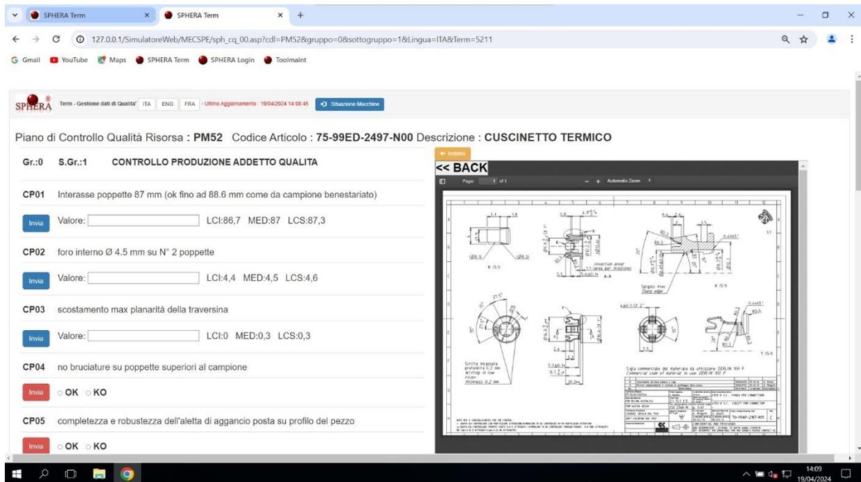
Il sistema registra tutti i controlli effettuati per ogni commessa/ordine lavoro/fase di lavorazione e azzerà il temporizzatore/contapezzi, in caso di check list in autocontrollo. Tutte le registrazioni sono disponibili ed accessibili per Ordine di Lavoro / articolo, si possono gestire le stampe dei certificati di qualità da archiviare o inviare con il prodotto ai clienti finali.
